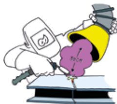
PLAATS BRONAFZUIGING DICHT OP JE LASWERK
